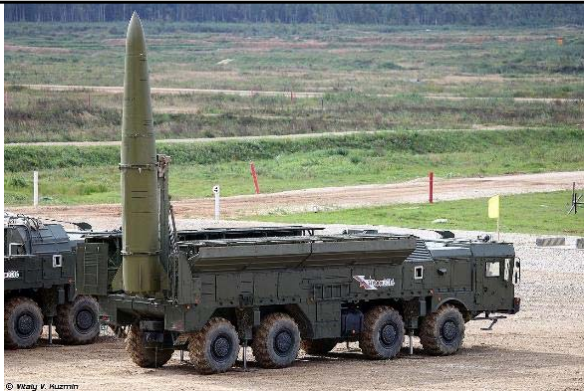
Искандер-М с ракетами 9М723К5 (9Р78-1 TEL of 9К720 Iskander-M SRBM 300m range Mach6 missile <2mins to target
